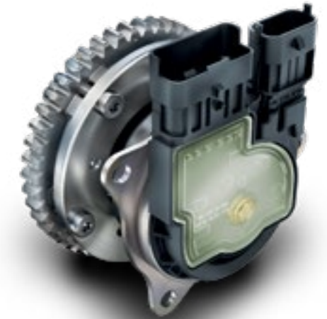
Elektromechanické nastavovače vačkových hřídelí: Elektronické systémy pro přestavení vačkových hřídelí umožňují oproti hydraulickým systémům dosáhnout vyšší rychlosti přestavení. To umožňuje zajistit agresivnější kalibraci rozvodů a dosáhnout minimalizaci aktivních zásahů do zapalování a vstříkávání paliva. Včasný přestavení do vyššího předstihu umožňuje, aby spalovací motor při akceleraci vytvořil rychleji krouticí moment, což znamená, že elektromechanické přestavače vačkových hřídelí nejen pomáhají dosáhnout vysoké provozní účinnosti, ale zajišťují také dobrý jízdní výkon.
