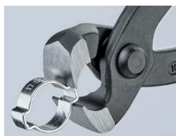
Použití čelního lisovacího výčnělku
