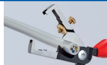
Indukčně kalené stříhací břity s přesným brusem pro řezání měděných a hliníkových kabelů bez přiskřípnutí do Ø 15 mm (5 × 2,5 mm 2 )
