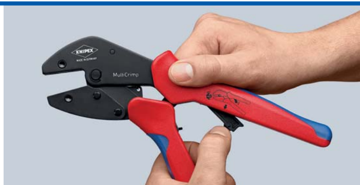
Poloha pro výměnu: Vyklopení servisní páčky pro nastavení rovnoběžnosti čelistí
