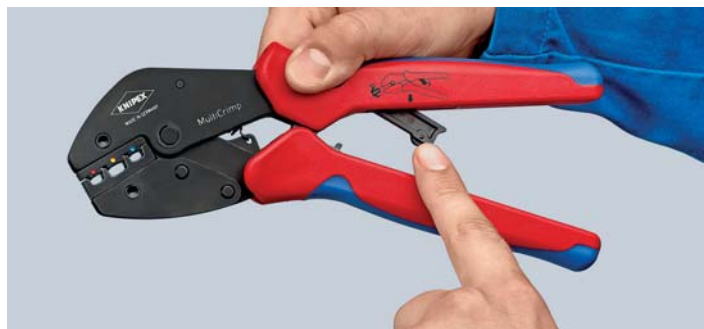
Sklepte servisní páku a promáčkněte kleště – jsou připraveny pro příští použití
