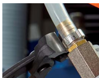
10 98 I220: Utěsnění připojení hadice na centrálním mazání
