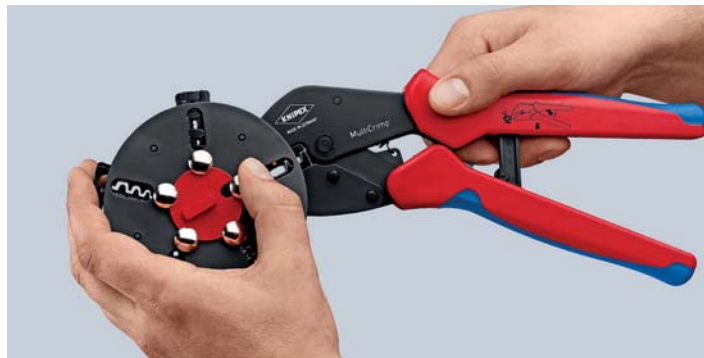
Výměna krimpovacího nástavce: Odaretuje polohu zásobníku, sejměte krimpovací nástavec z kleští.
