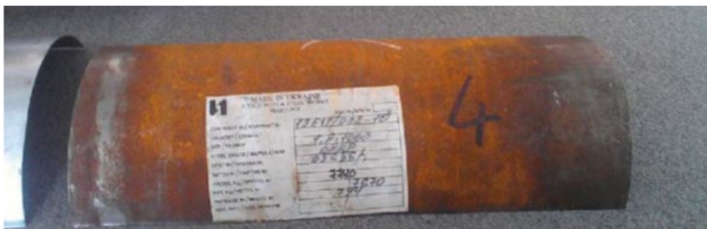
Zadní tlumič výfuku na Škodu Fabii I polského výrobce rozšířené značky. Ten je 2 plášťové konstrukce, kdy oba pláště musí být pohlinikované. Vnitřní plech je ale v tomto případě čistý surový plech. To znamená, že by zde koroze nastala již po několika kilometrech. Tento výfuk je ale zcela „nový“.
