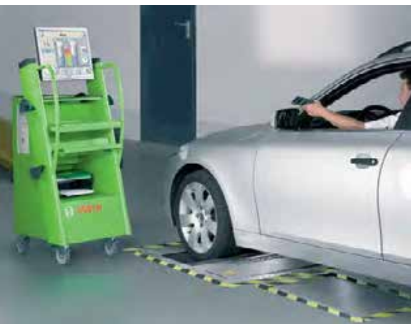
Kompletní brzdová zkušebna a diagnostická linka
