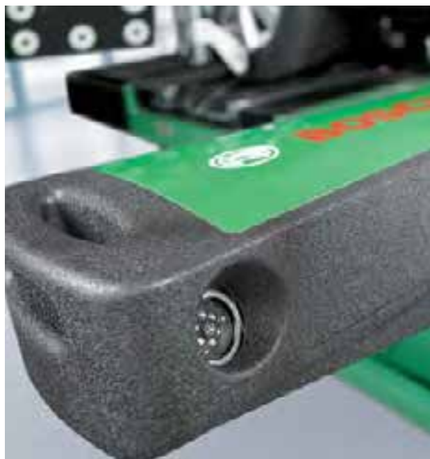
Snímače měřených hodnot s CCD-kamerou
