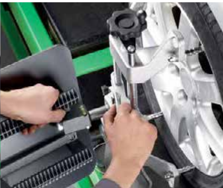
Jednoduchá montáž – je nutné pouze jedno seřízení tabulí
