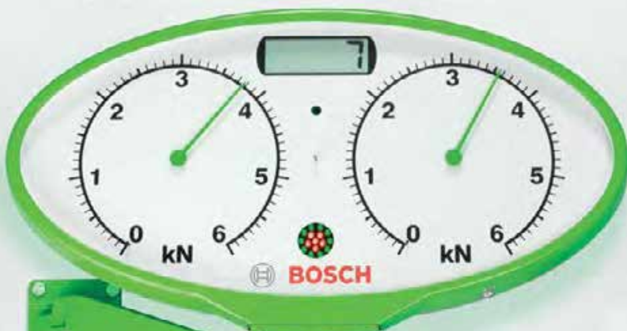
BSA 4211 se sériově dodává s paralelní indikací a s displejem LCD.
